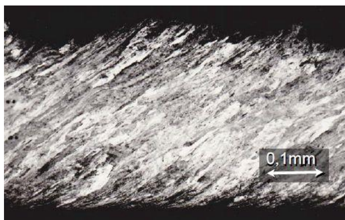
1. ábra. Vízben edzett D75 acél forgácsa
